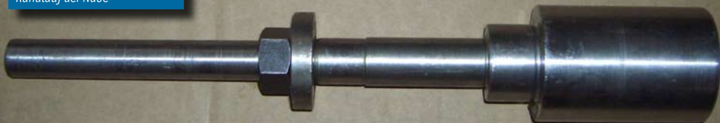
Aufnahme zur Überprüfung des Rundlauf der Nabe
