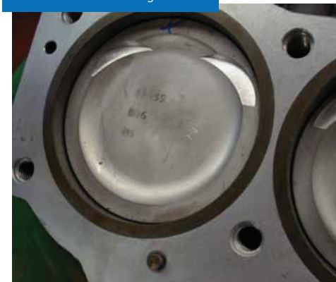
Reparierter Motorblock mit Tophat Liners. Besser als das Original
